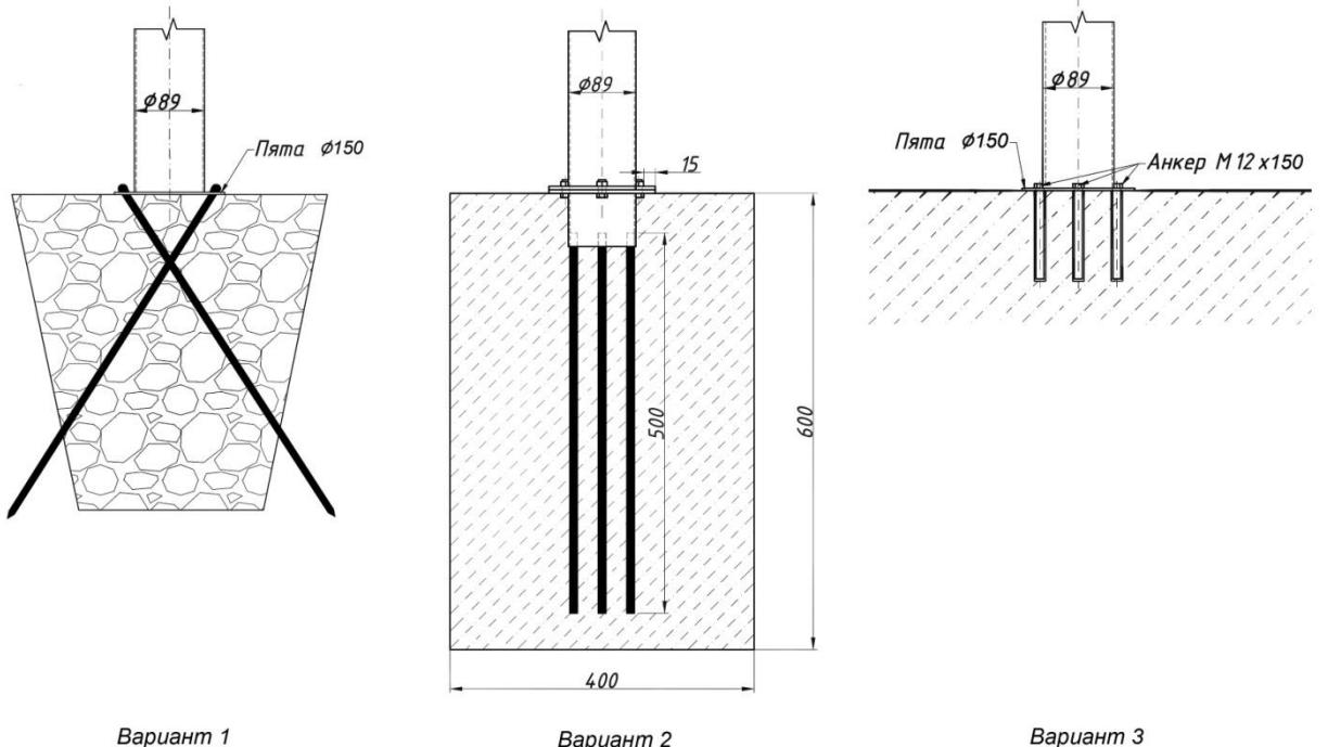
шпильками. После застывания бетонной смеси (до 3-х суток) на встречные закладные устанавливаются стойки оборудования и фиксируются посредством резьбовых соединений с усилием затяжки не менее 30-35 Нм.\*
